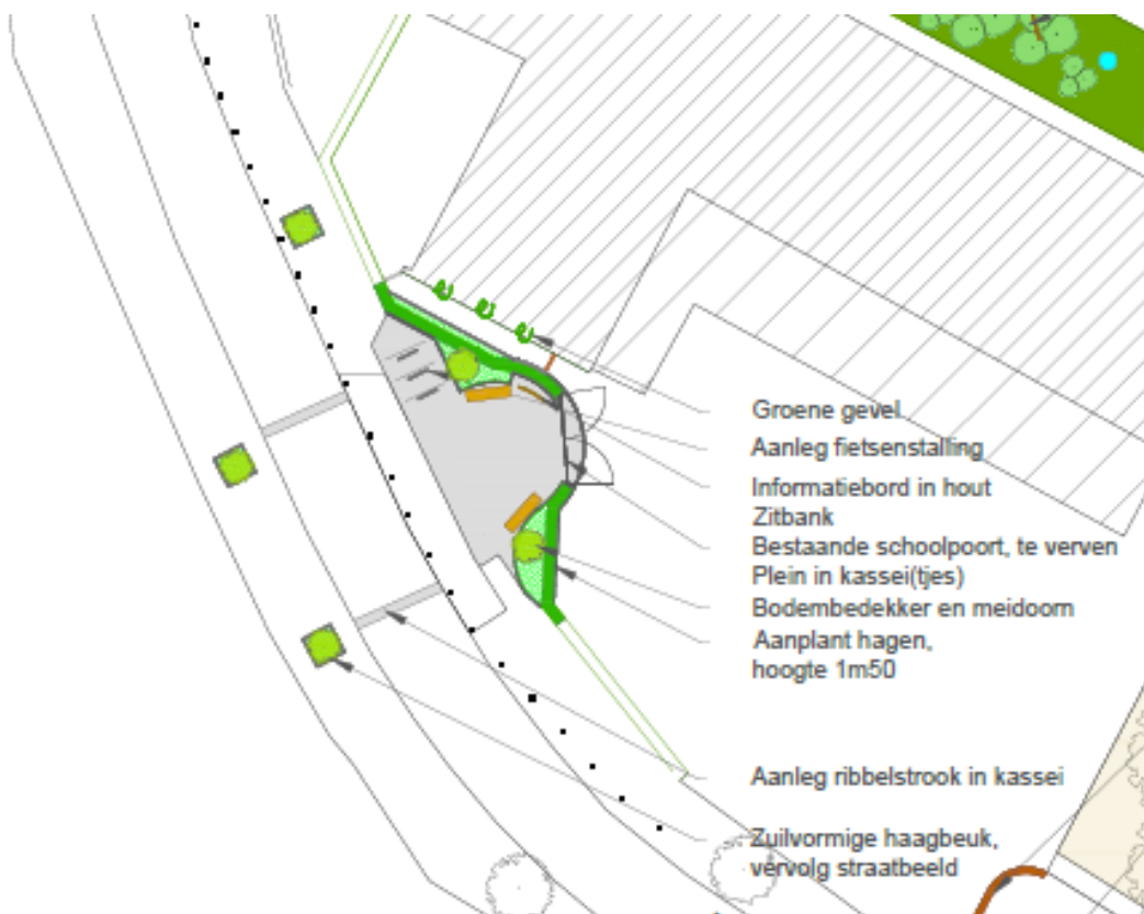
Heraanleg toegang kleuterschool in functie van veiligheid en betere visuele verbinding met de vallei van de Kapittelbeek
